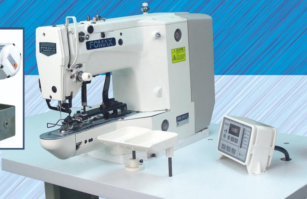
Máquinas de coser botones electrónica equipada con 33 programas (ver gráfico adjunto) diferentes para coser botones de 2,3 o 4 agujeros. Incorpora programador electrónico para modificar el programa de costura de botones. Se pueden programar secuencias de botones según necesidades del trabajo a realizar. También es posible modificar fácilmente la longitud de las puntadas de cada programa según la distancia entre agujeros de cada botón mediante el programador de costuras..
